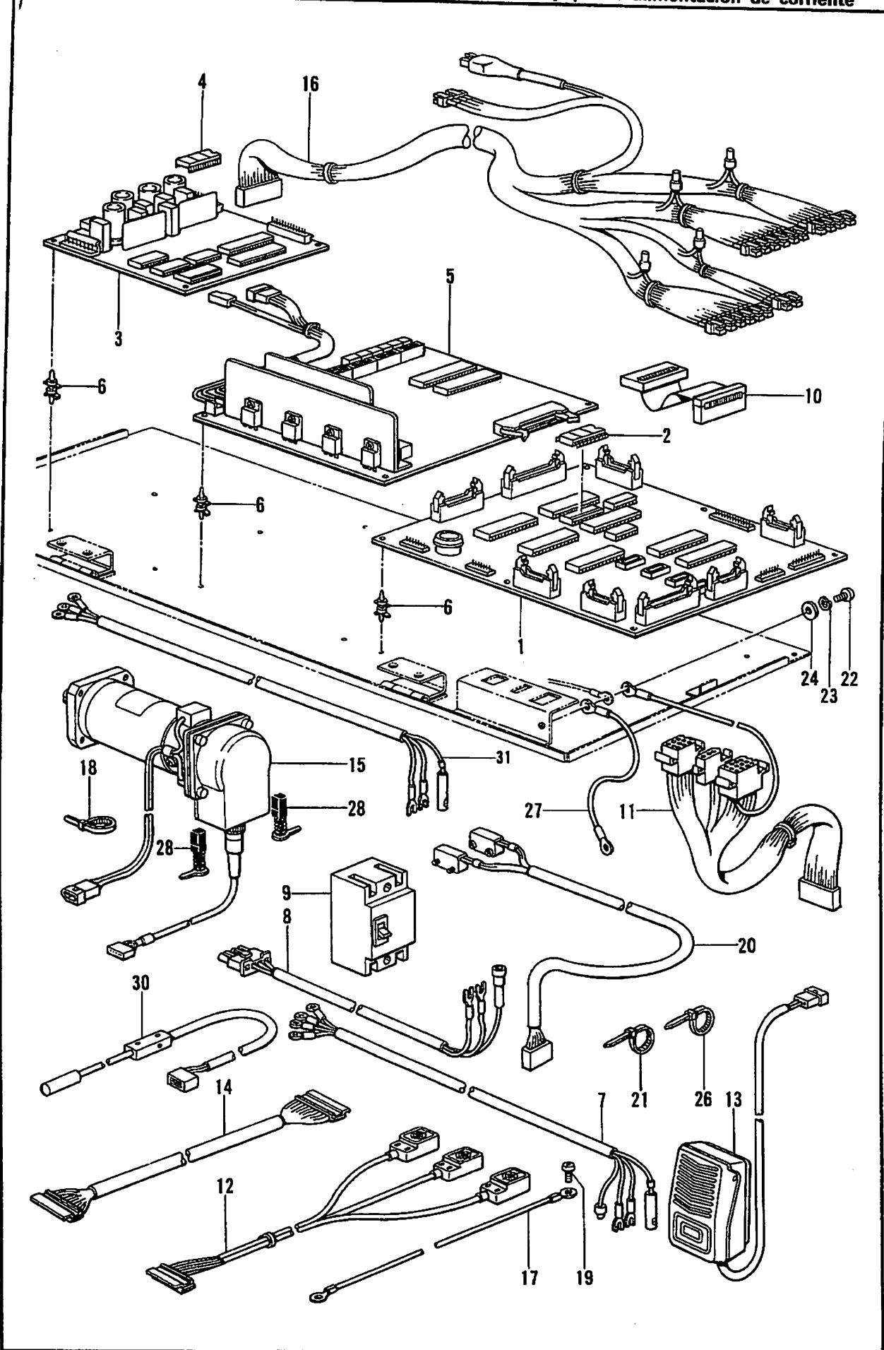
S. 電菱品関係/Power supply equipment mechanism/Stromversorgung/Mécanisme de l'équipement en alimentation électrique/Mecanismo del equipo de alimentación de corriente
