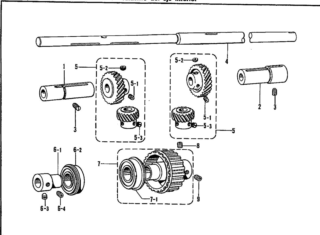
D. 針棒切換工操作関係 / Needle bar flip-up mechanism / Nadelstangehochstellung /
