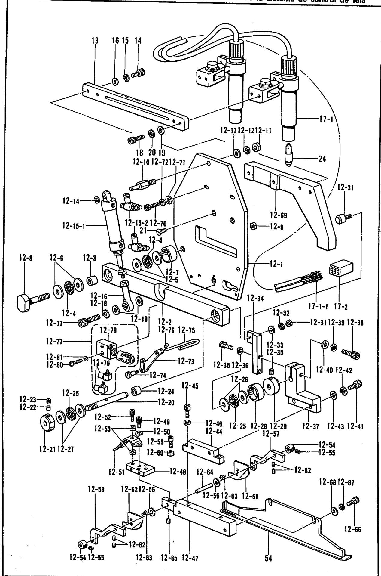
T. 布制御関係/Cloth control system mechanism/Stoffführungs vorrichtung /
