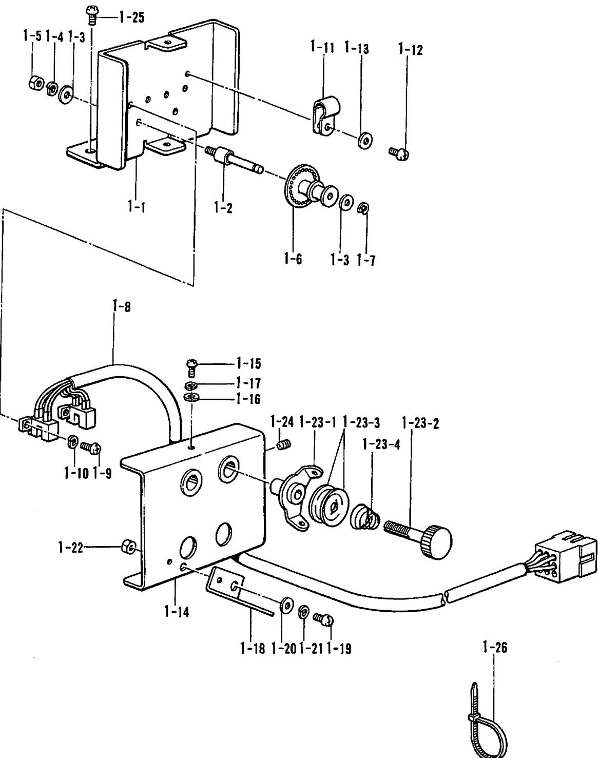
K. 糸ユルメ関係/Tension release mechanism/Spannungsverminderungsvorrichtung/
