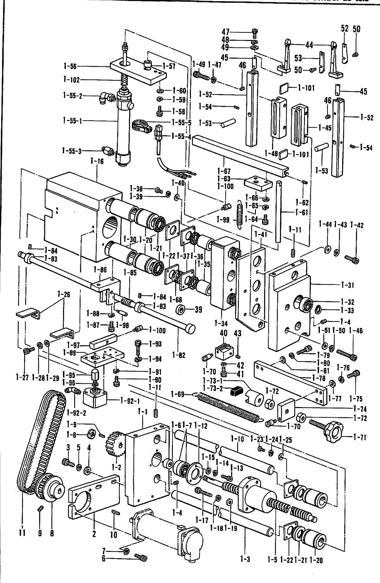
T. 布制御関係/Cloth control system mechanism/Stoffführungs vorrichtung/
