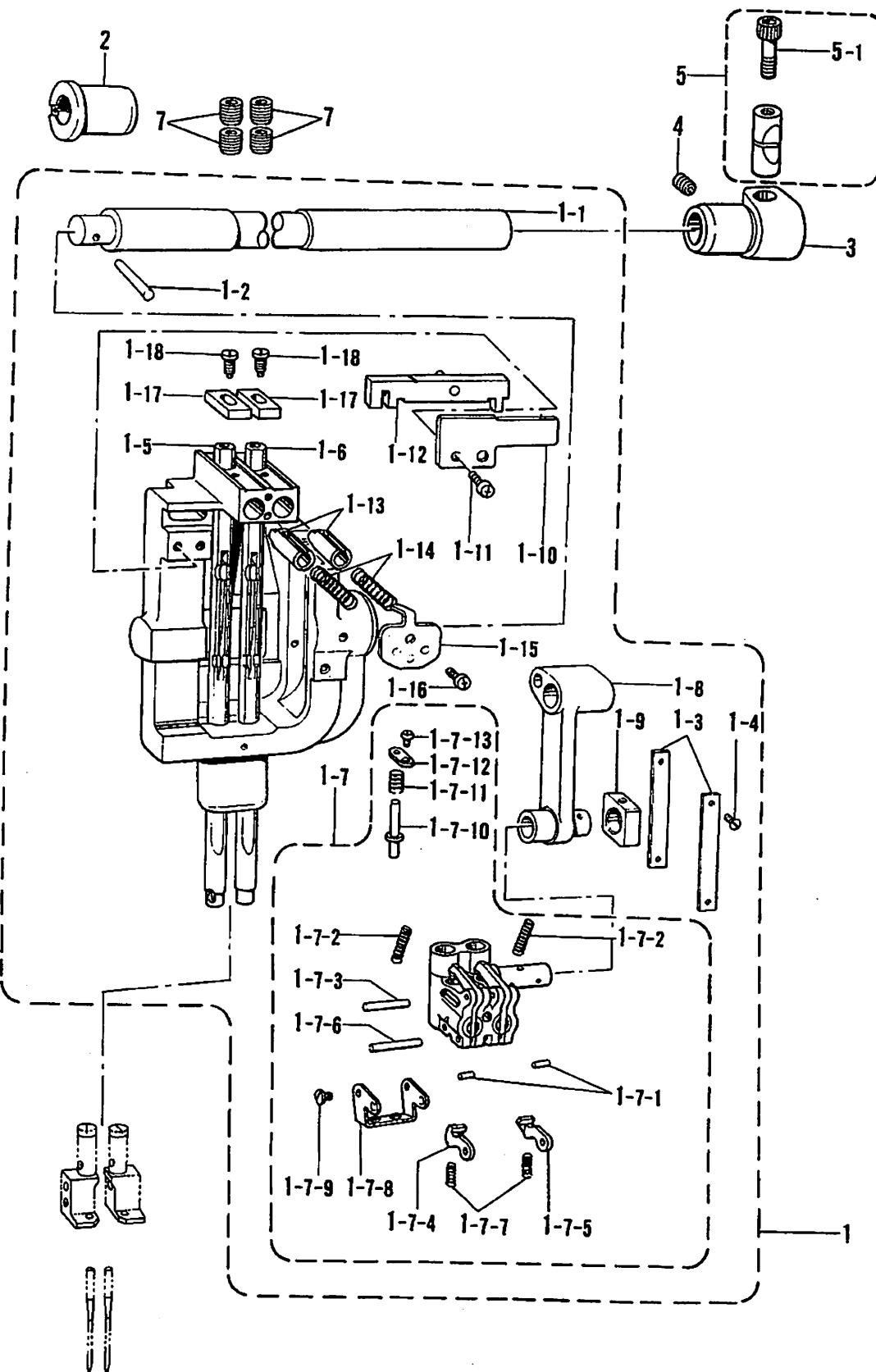
C. 針棒搖動関係/Needle bar rocking mechanism/Nadelstangenbetätigung/
