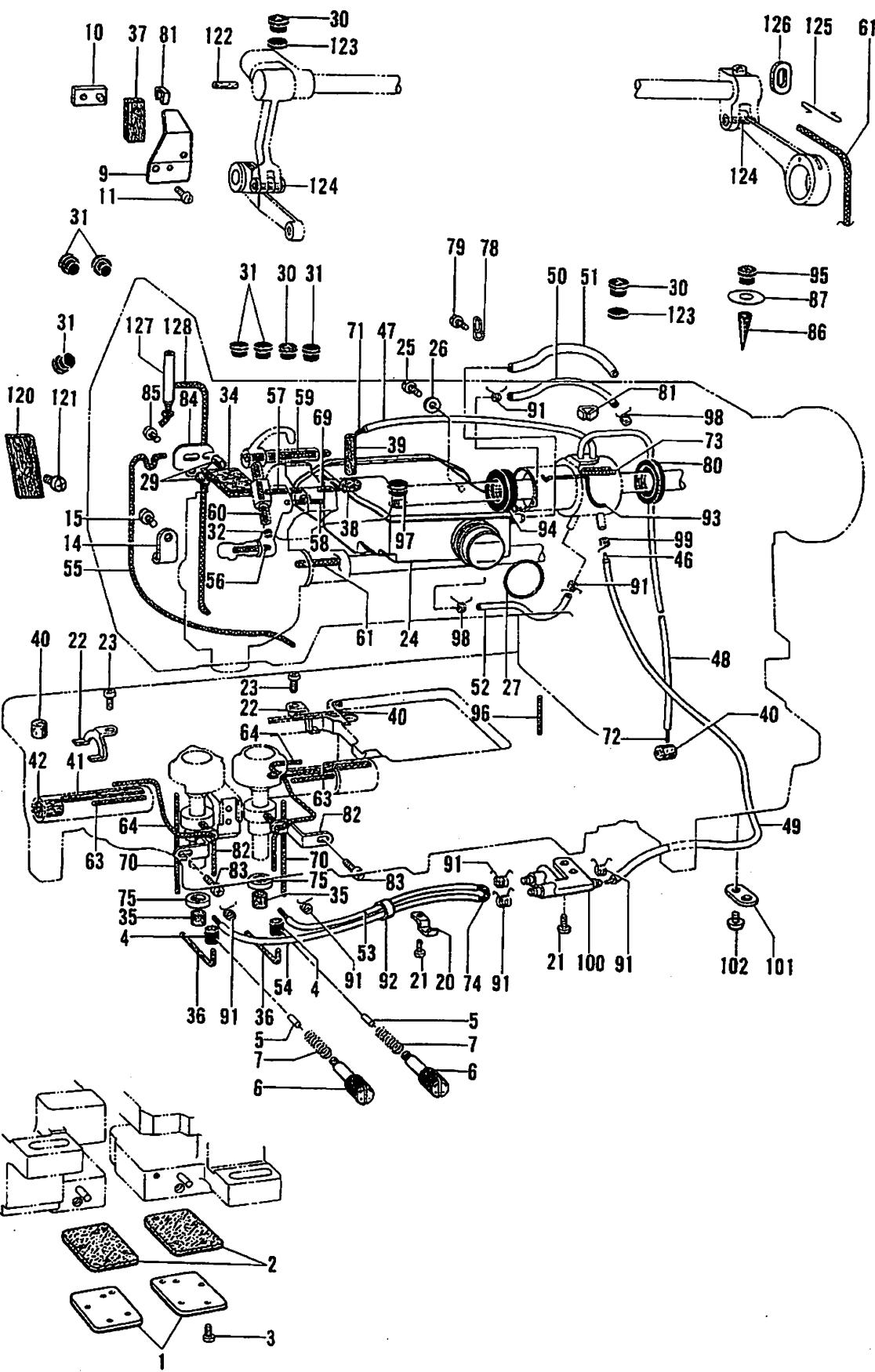
H. 給油潤滑関係/Lubrication /Schmierung /
