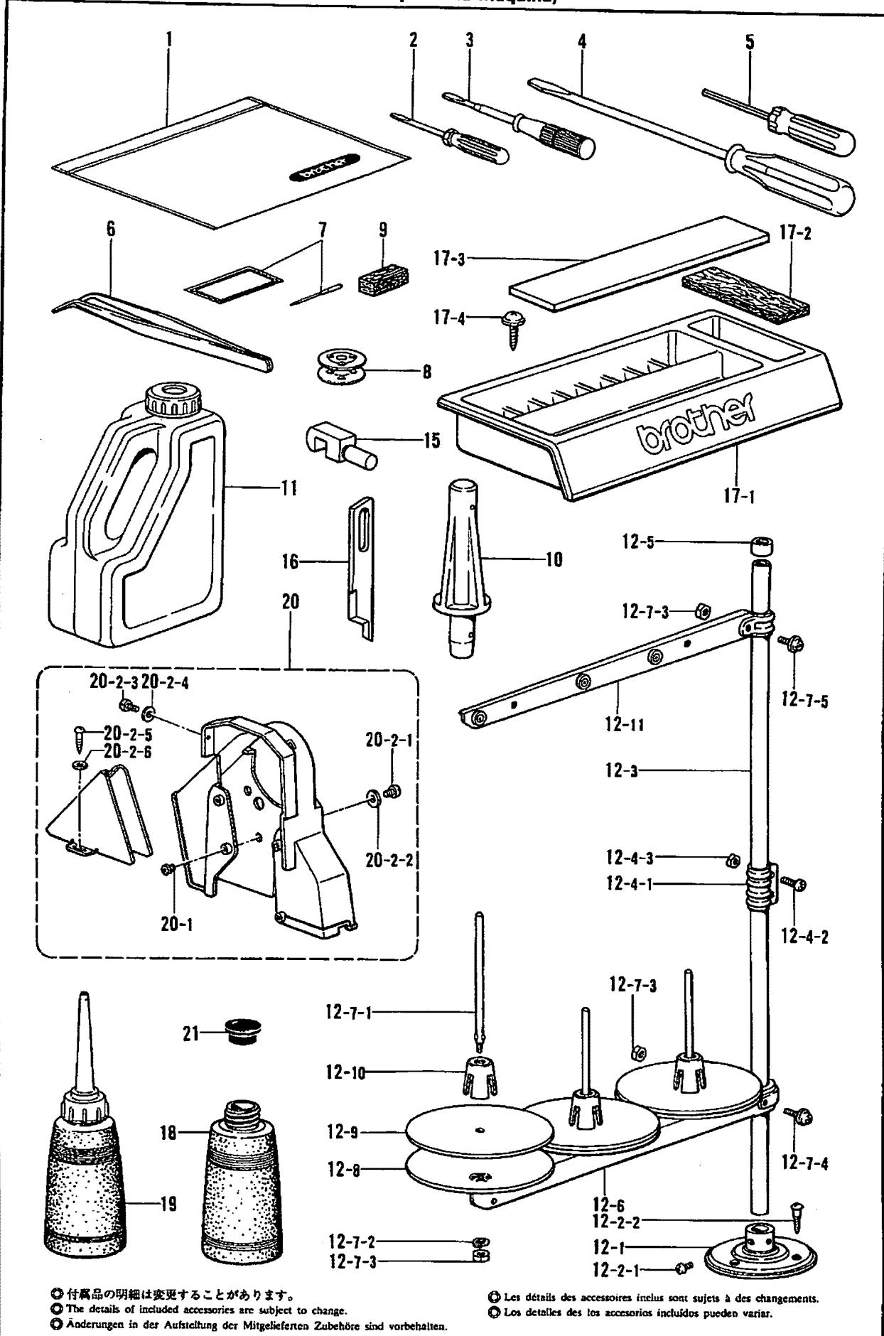
Z2. 付属品関係(頭部付属)/Accessories (provided with machine) / Zubehör (mit Nähmaschine)/
