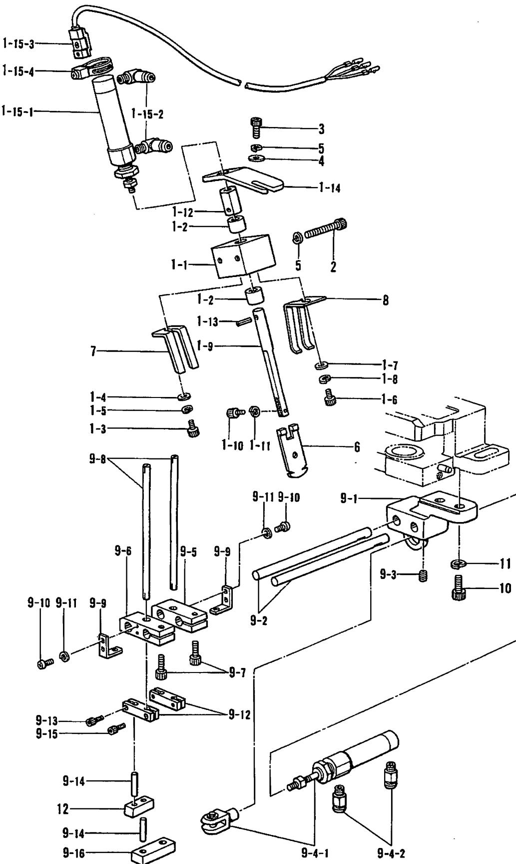
N. 糸切り関係/Thread trimmer mechanism/Fadenabschneidevorrichtung/
