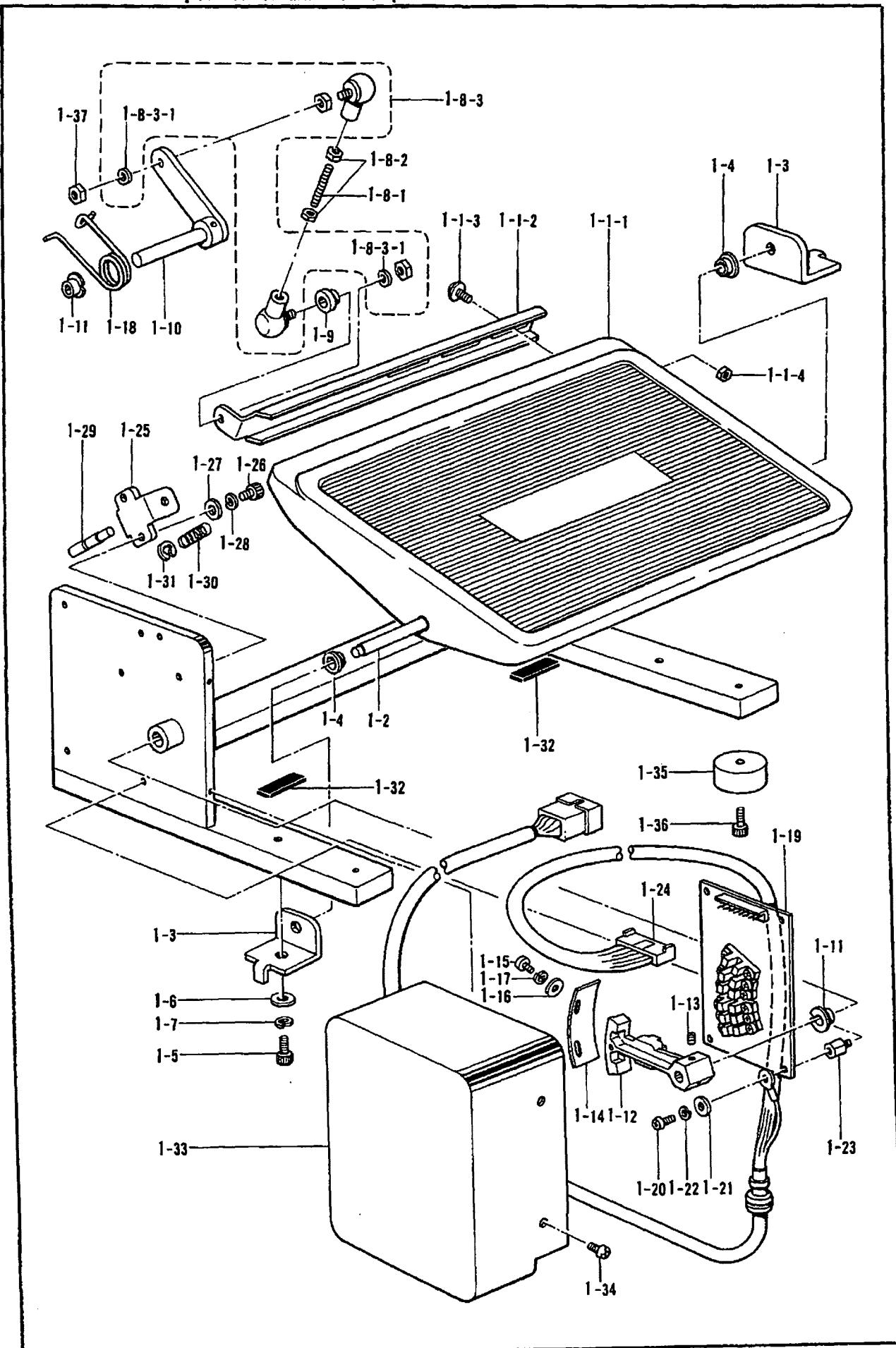
U. 踏板関係/Treadle mechanism/Fußbetätigung/
